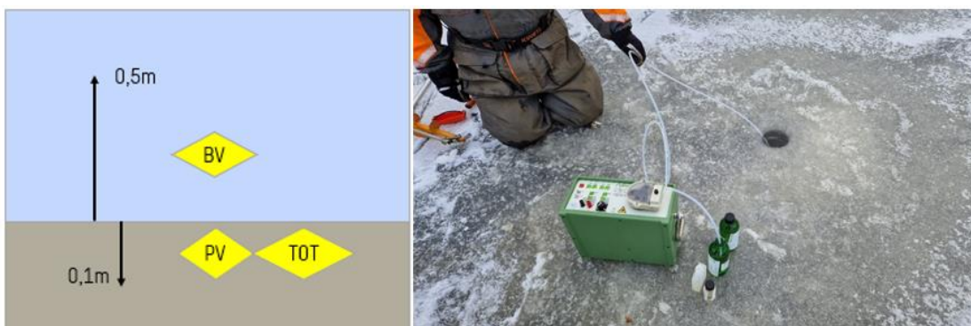
Figur 9. Bilden till vänster visar en schematisk bild över vart bottenvatten och sediment för analys av totalhalter och porvatten provtogs. Till höger visas provtagning av bottenvatten med hjälp av peristaltisk pump.
