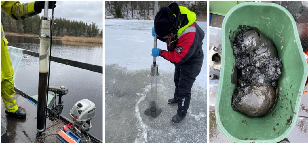
Figur 8. Till vänster och i mitten visas rörprovtagare som användes vid provtagning av sediment till porvattenanalys. Till höger visas exempel på sediment "proppen" som uppstod från nivå 10-50cm djup, som mestadels var kraftigt oljepåverkat.
