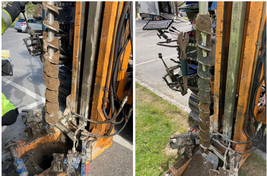
Figur 6. Påträffade fyllnadsmaterial i punkt CWM02 (vänster; 0–1,0 m.u.my) och punkt CWM03 (höger; 0–1,0 m.u.my.).
